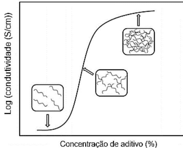
Figura 1 – Três estágios da condutividade elétrica de compósitos e distribuição das partículas na matriz.
