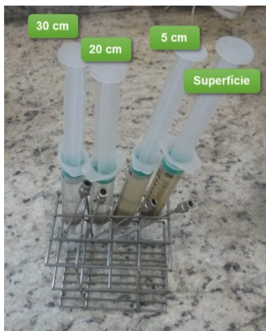
Figura 13 - Exemplo de amostra do meio filtrante antes da limpeza.
