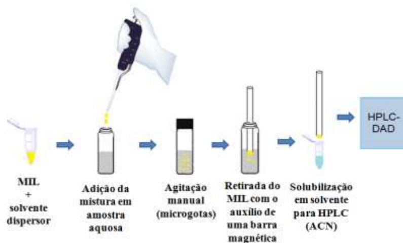
Figura 17 – Visão geral do procedimento de extração usando a abordagem baseada em DLLME/MIL.
