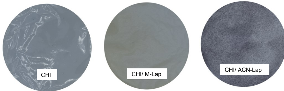
Figura 21- Filmes desenvolvidos à base de quitosana, M-Lap e ACN-Lap (foto em fundo branco).
