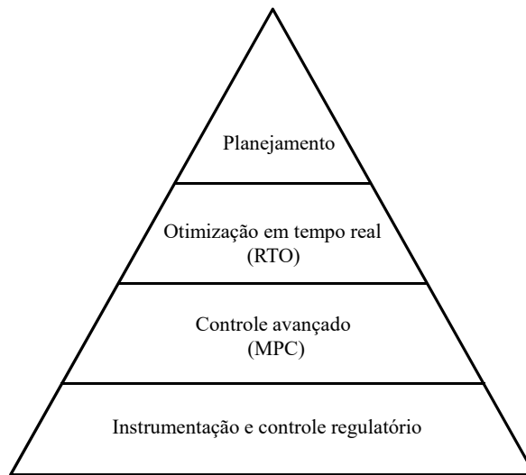
Figura 4 – Camadas dos sistemas de automação e controle industriais. Fonte: (CAMPOS et al. , 2013)
