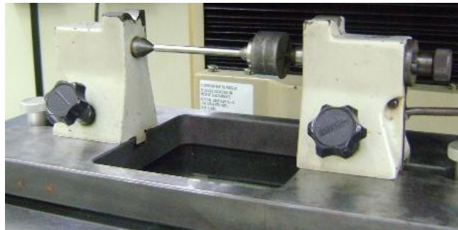
Figura 45. Fixação mola para medição de batimento – Fonte: Empresa A
