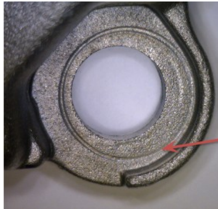
Figura 13. Marca da cunha de vedação na tampa – Fonte: Autora.
