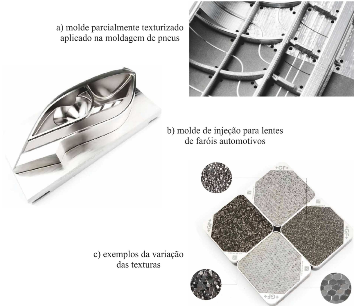
Figura 2 – Exemplos de superfícies texturizadas com laser em moldes e de variação das texturas empregadas.
