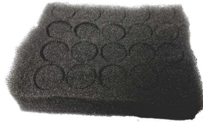
Corte de cilindros de poliuretano
