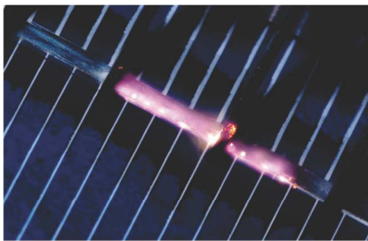
a) soldagem de interconectores presentes nas células
