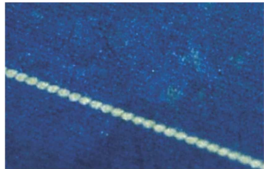
d) linha removida em uma camada de nitreto de silício
