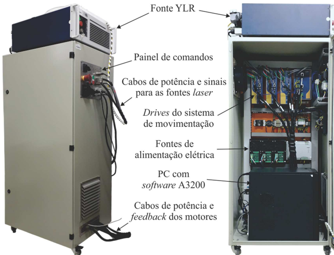
Figura 43 – Visão externa e interna do gabinete elétrico da bancada experimental.
