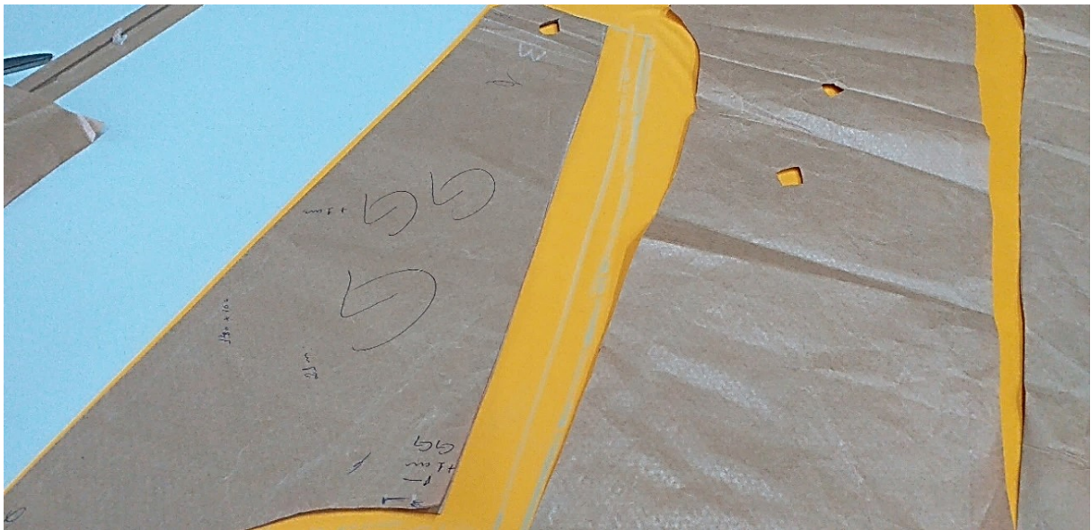
Figura 39 – Molde de peça simétrica sendo encaixado.
