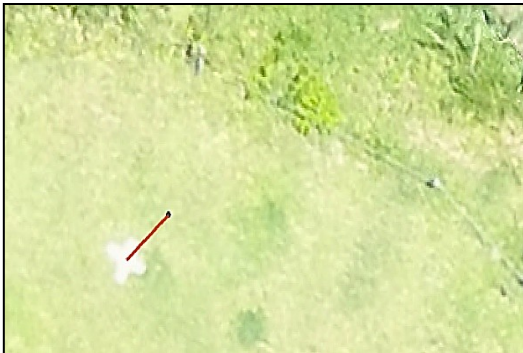
Figura 14 - Discrepância entre um ponto de verificação em solo e a coordenada obtida com RTK/GNSS.
