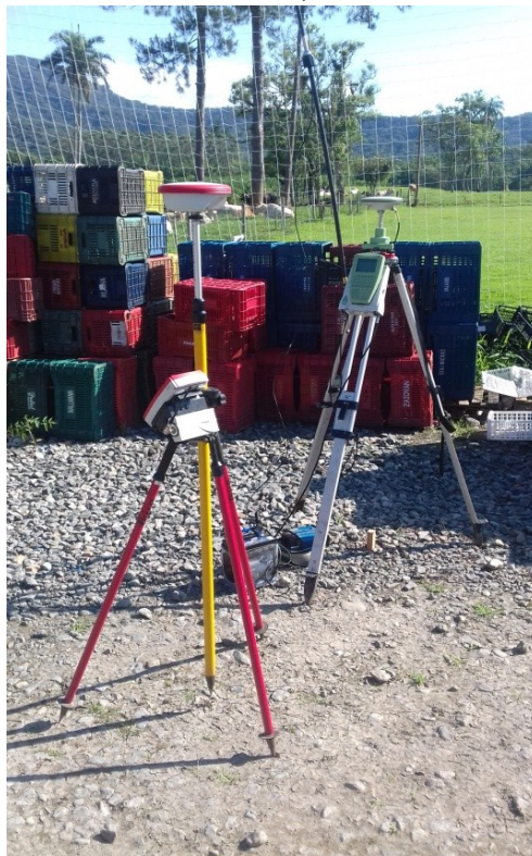
Figura 9 - Sistema RTK/GNSS, controladora e antena.
