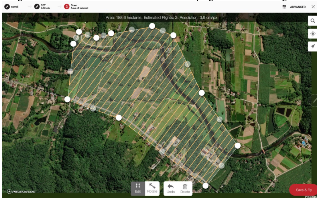
Figura 10 - Plano de voo do VANT elaborado no programa Precision Flight.
