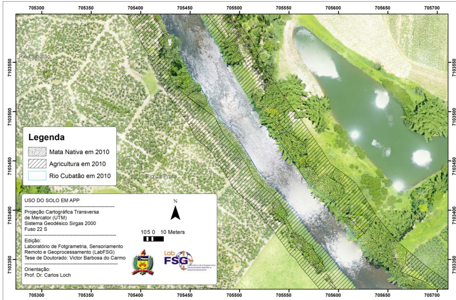
Figura 17 - Restituição do Rio Cubatão em 2010 sobreposta na imagem de 2017. As áreas ocupadas com mata nativa foram marcadas com pontilhados e as áreas ocupadas com agricultura receberam hachuras simples.
