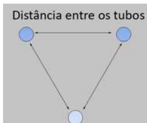
Figura 19 – Arranjo triangular dos tubos.
