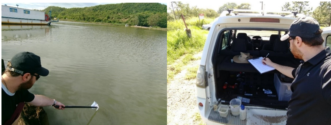
Figura 5 - Realização dos trabalhos de campo. A: Coleta realizada com o uso de coletor plástico de 1 litro com haste alongável de 2 metros a partir da margem do rio. B: Medições e notas complementares.
