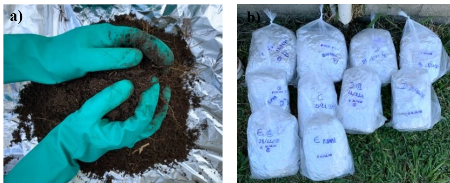
Figura 36 - Coleta de amostras dos reatores. a) Amostras coletadas revestidas em papel alumínio. b) Amostras embaladas em saco plástico, prontas para serem congeladas.
