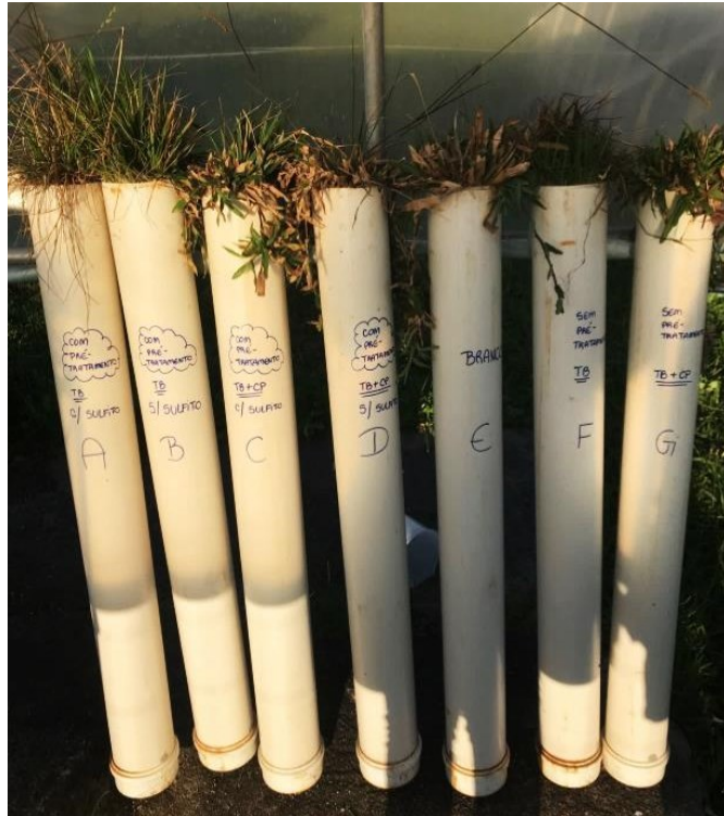
Figura 29 - Reatores biobed a serem abertos no primeiro período de coleta de amostras.
