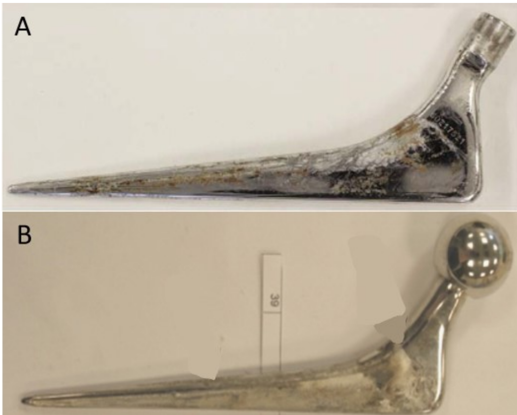
Figura 17 – Imagem de um implante removido, ou explante, com elevado grau de fretting-corrosion na superfície da haste que estava em contato com o cimento.
