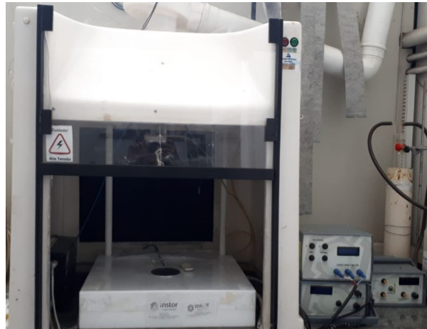
Figura 21 - a) Equipamento utilizado para a realização do processo de eletrofição, b) Esquema do processo de eletrofição.
