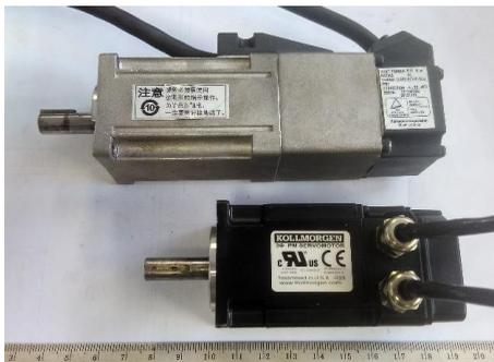
Figura 4.2 – Comparativo das dimensões dos servomotores utilizados nos experimentos: Panasonic (acima) e Kollmorgen (abaixo).
