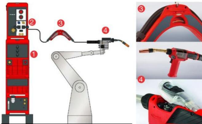
Figura 3.2 - Disposição de componentes básicos do sistema CMT. 1) Fonte de alimentação; 2) Cabeçote alimentador de arame; 3) Buffer de arame; 4) Tocha de soldagem. [1]
