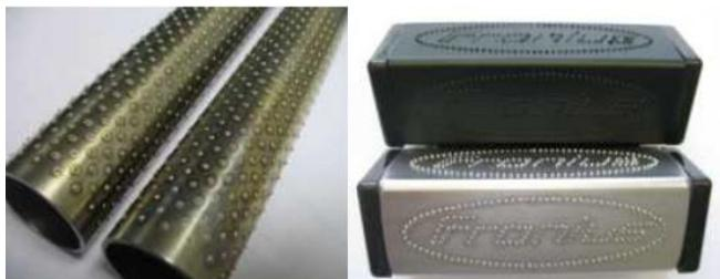
Figura 3.16 – Peças com acabamento realizado pela variante *CMT Print* [8].
