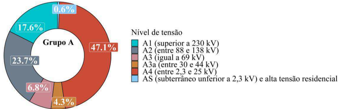
Figura 14 – Percentual de consumo de energia elétrica na rede por nível de tensão do Grupo A
