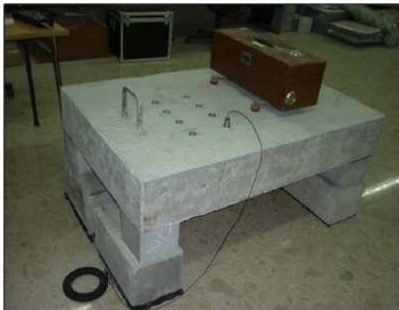
Figura 7: Modelo reduzido para medição da redução da transmissão sonora de impacto.
