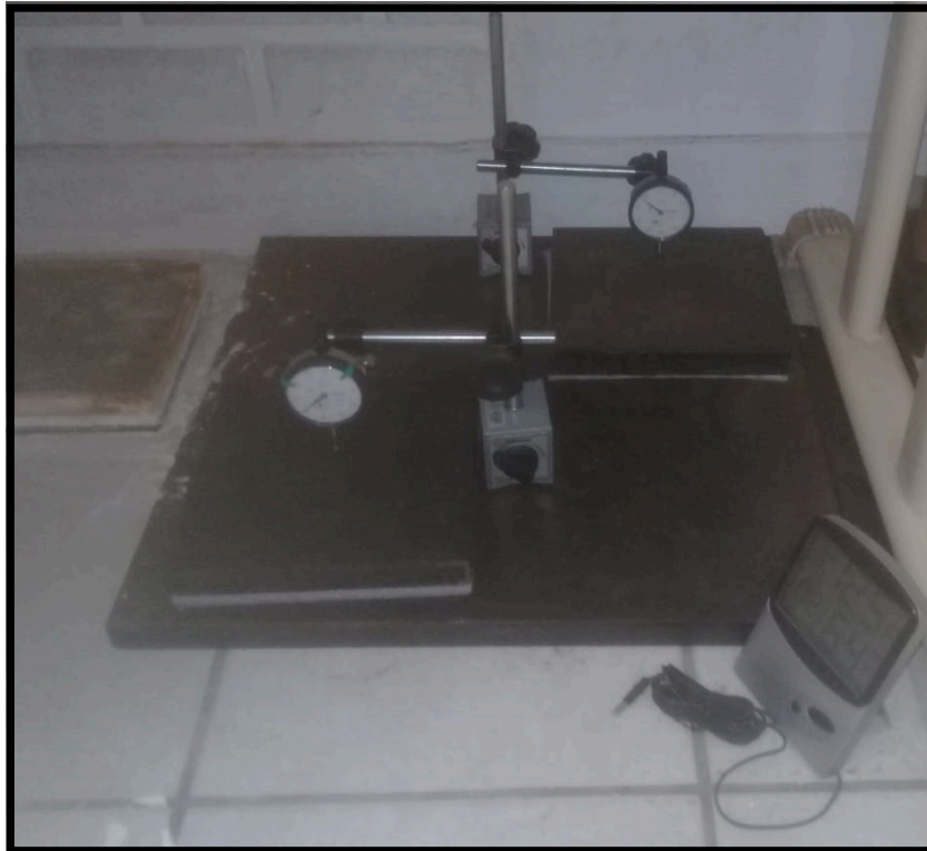
Figura 17: Bancada teste de rigidez dinâmica x fluência à compressão.
