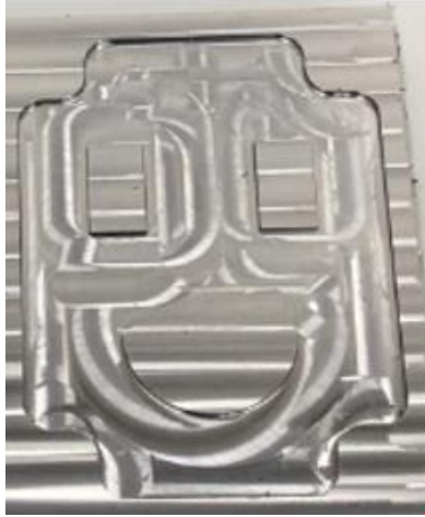
Figura 50 - Cavidade usinada com parâmetros indicados na pesquisa.
