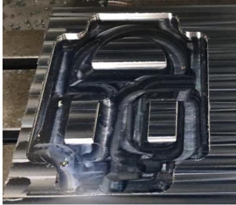
Figura 44 - Cavidade usinada - software Fusion.
