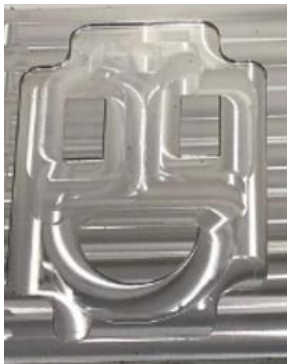
Figura 47 - Cavidade usinada com parâmetros propostos pelo software NX.
