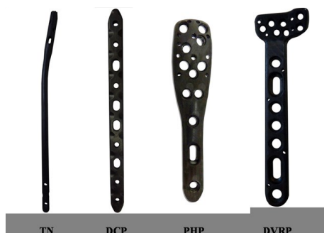
Figura 17. Placas de CRF-PEEK testadas: TN- placa tibial, DCP - placa de compressão dinâmica, PRP - placa do úmero proximal e DVRP - placa radial distal.
