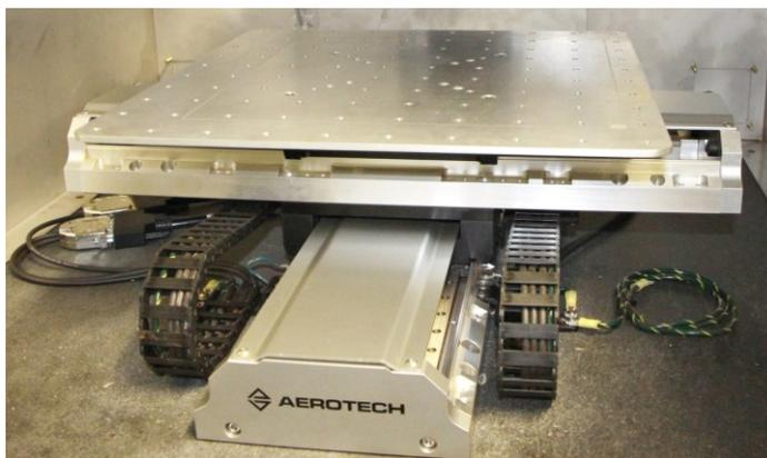
Figura 3.5 - Mesa de movimentação linear de duas coordenadas com motor linear comandada numericamente [Autor].
