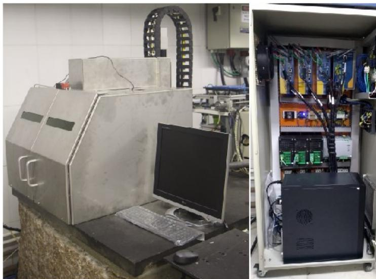
Figura 3.7 - Bancada experimental, destacando a unidade de processamento LASER, o computador e o conjunto eletrônico do sistema de comando [Autor].
