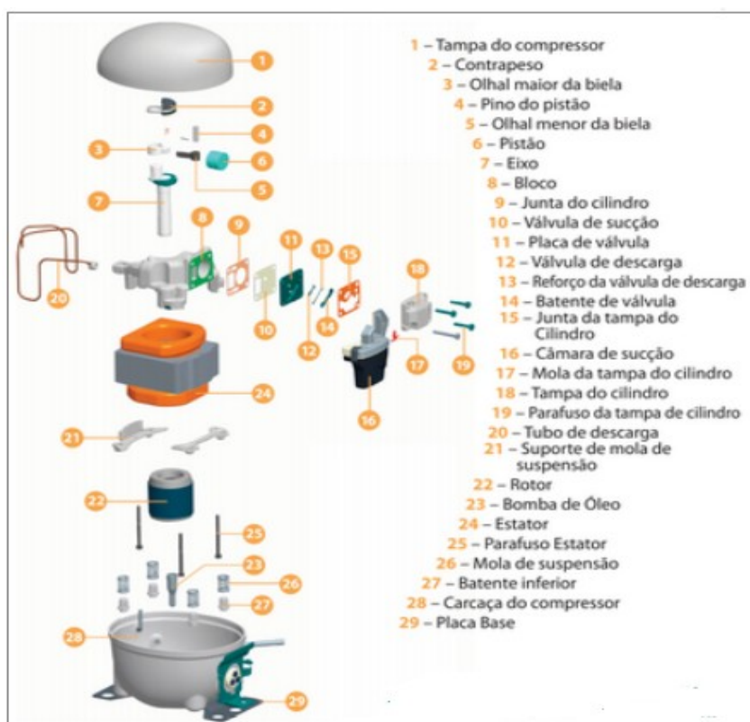
Figura 3.2: Componentes de um compressor hermético
