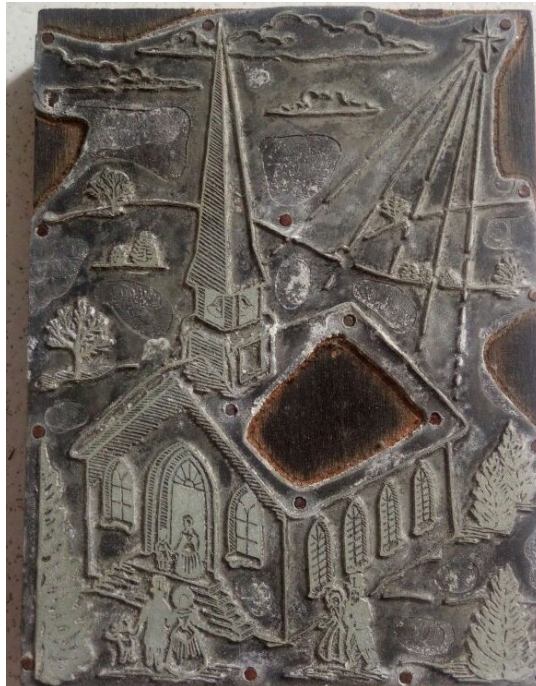
Figura 7 - Clichê em madeira e latão para a impressão da capa do livro O Coelho do Halo Azul
