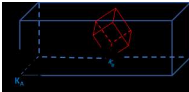
Figura 33 – Sistema coordenado da amostra ( K_A ) e sistema coordenado do cristal ( K_B )
