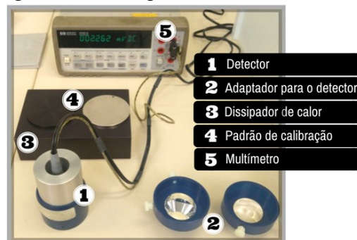
Figura 18 – Componentes do emissômetro
