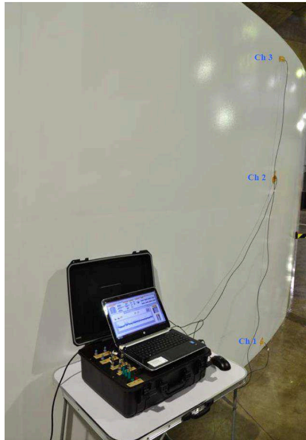
Figura 45: Fotografia da montagem de medição com o protótipo na unidade geradora 1 em UHSO.
