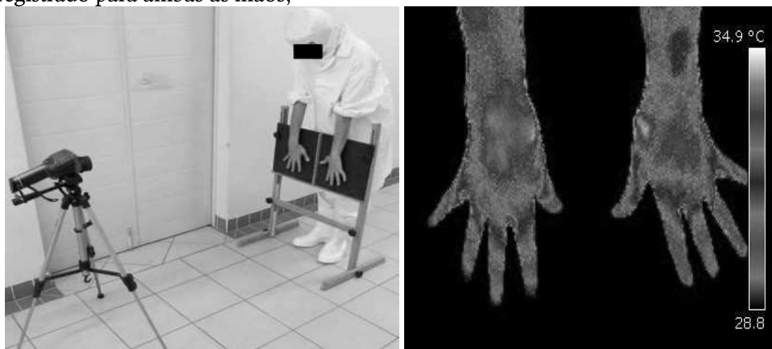
Figura 1, Câmera portátil infravermelha e quadro para capturar as imagens termográficas
