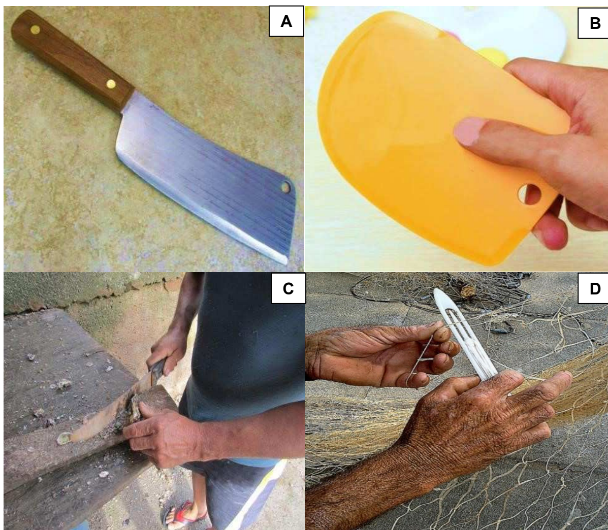
Figura 3 - Algumas ferramentas utilizadas nos cultivos de moluscos: (A) Cutelo; (B) Raspador; (C) Faca/Facão e (D) Agulha para conserto/manutenção das redes e lanternas.
