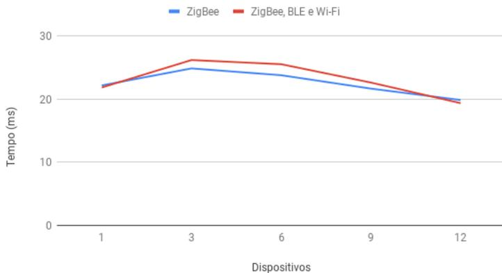
Figura 28 – Resultado ZigBee - Média do Tempo de Resposta.
