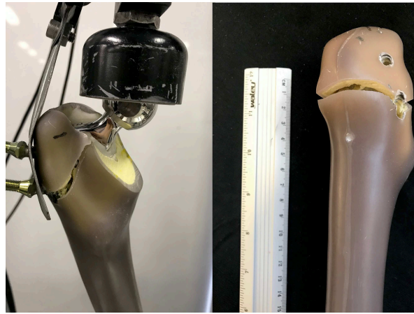
Figura 59 – Detalhe do local de fratura do osso sintético.
