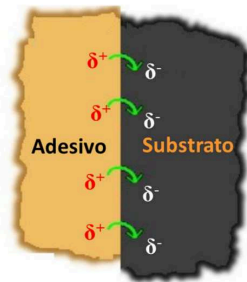
Figura 16 – Esquema do processo de adesão por atração eletrostática, onde \delta^+ e \delta^- , representam cargas positivas e negativas respectivamente.
