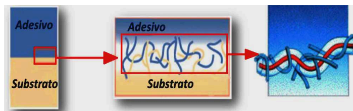
Figura 17 – Esquema do emaranhamento no processo de interdifusão.
