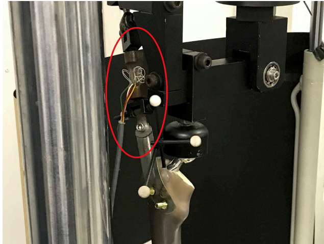
Figura 61 – Disposição da célula trocantérica em um ensaio preliminar estático.
