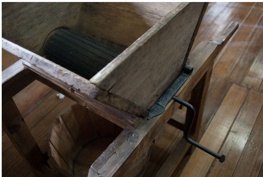
Figura 21: Desengaçadeira utilizada para esmagar a uva. Detalhe para o cilindro coberto de pregos em seu interior
