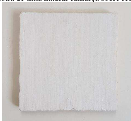
Figura 72 - Amostra de tinta natural camurça sobre reboco de cal e terra
