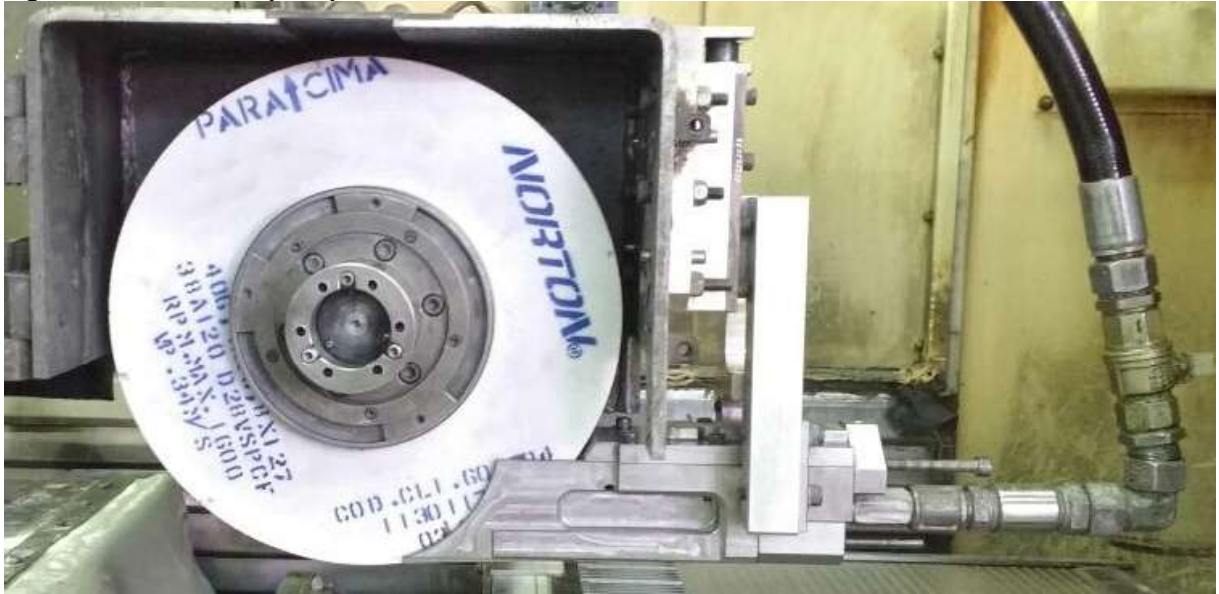
Figura 3.21- Tubeira tipo sapata instalada na retificadora.
