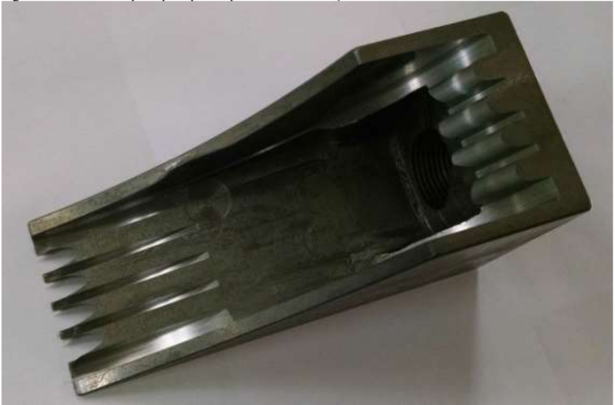
Figura 3.8 - Tubeira tipo sapata protótipo fabricada em aço SAE 1020.
