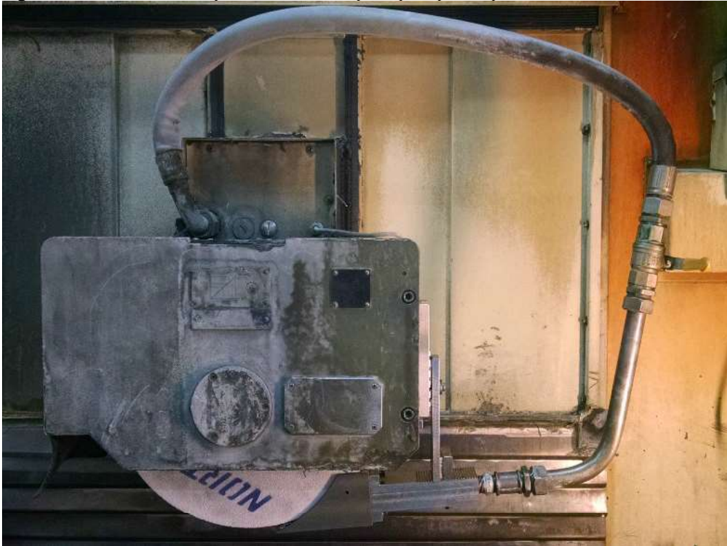
Figura 3.10 - Sistema completo da tubeira tipo sapata protótipo instalado na retificadora.
