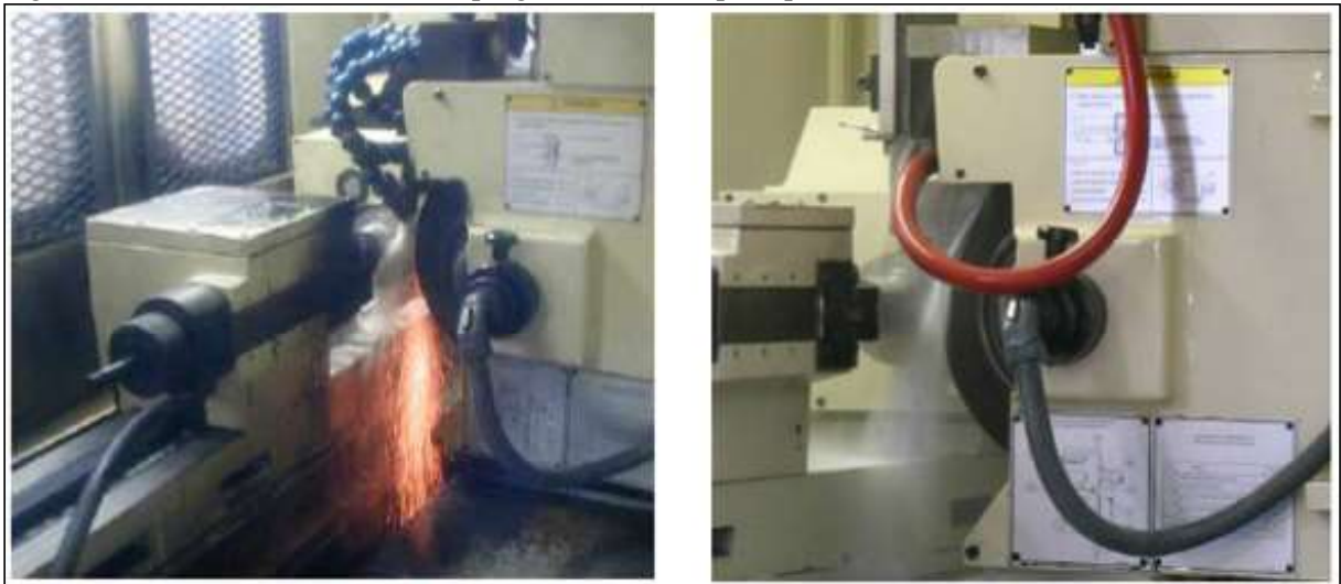
Figura 2.11 - Redução de faíscas empregando tubeira tipo sapata.
