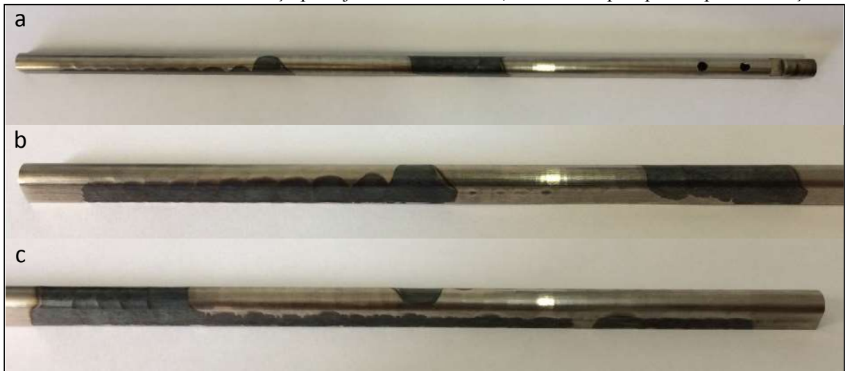
Figura 4.12 - Lamela retificada em condição do primeiro desbaste com tubeira de jato livre para a velocidade de avanço planejada de 80 mm/min, danificada por queima por retificação.
