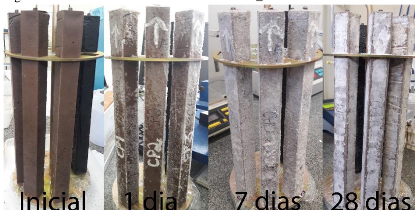
Figura 1 - Desenvolvimento de eflorescências 70_CZP
