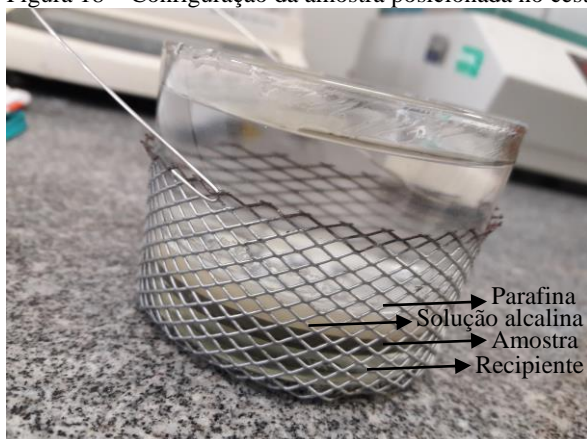
Figura 18 – Configuração da amostra posicionada no cesto da retração química
