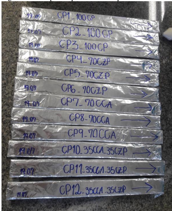
Figura 19 – Corpos de prova vedados para análise de retração autógena
