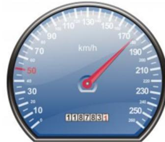
Exemplo de um velocímetro analógico fazendo o registro da velocidade sem saltos.
