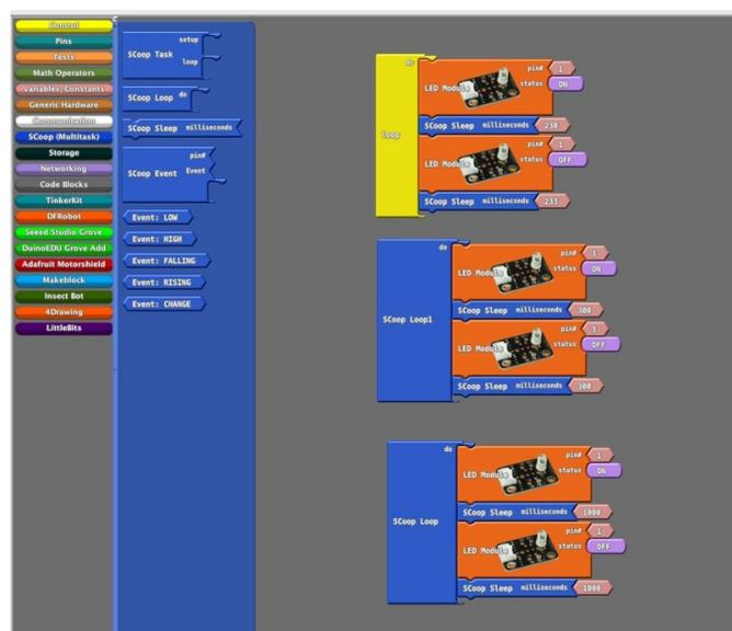
Figura 3.7: Exemplo de programação com Ardublock.
