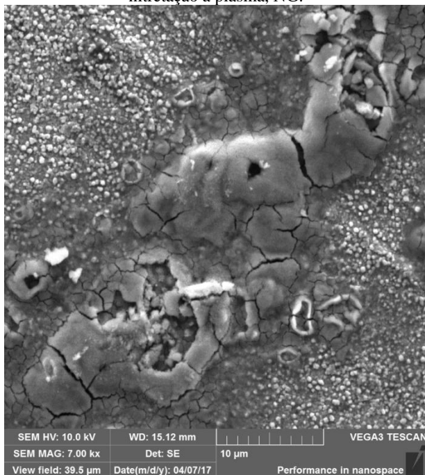
Figura 78 Imagem de MEV de um dos pontos que apresentou maior profundidade de corrosão observada na superfície da amostra tratada por nitretação a plasma, NG.
