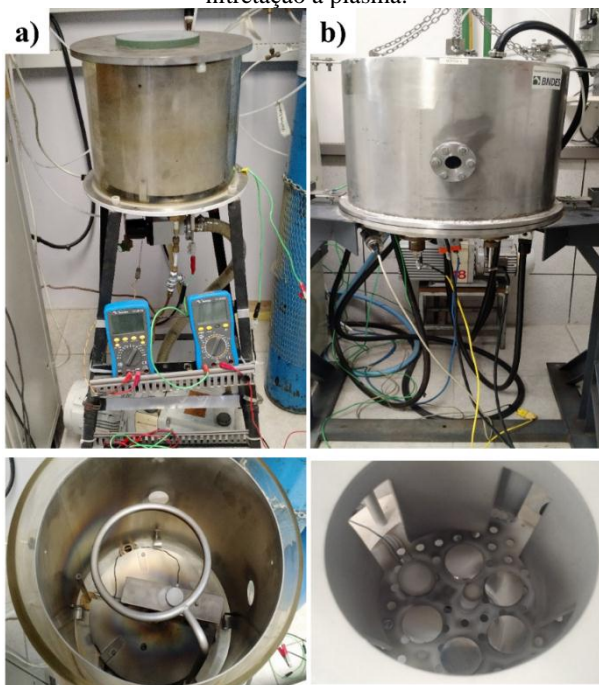
Figura 16 - a) Imagem externa e interna do reator de vidro, utilizado para obter a fase \epsilon , b) imagem externa e interna do reator CHN1 (reator desenvolvido e montado pelo LabMat – UFSC), utilizado para obter a fase \gamma' no processo de nitretação a plasma.
