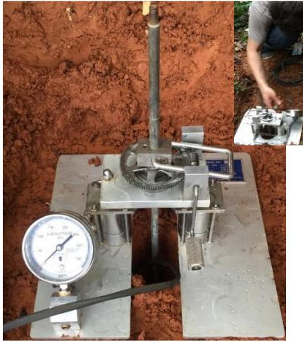
(c) Após 15 minutos, verificar se houve variação na tensão confinante e realizar o giro da manivela para cisalhar o solo. Neste passo deve-se ficar atento aos valores registrados pelo manômetro, uma vez que, ele registrará a tensão cisalhante.
