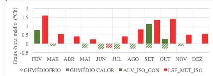
Em **Vitória da Conquista**, houve maior desconforto por calor do que por frio, nos dois modelos. Como pode ser observado no Gráfico 18, o modelo LSF\_MET\_ISO apresentou apenas desconforto por calor, com temperaturas operativas superiores ao limite de conforto, entre os meses
