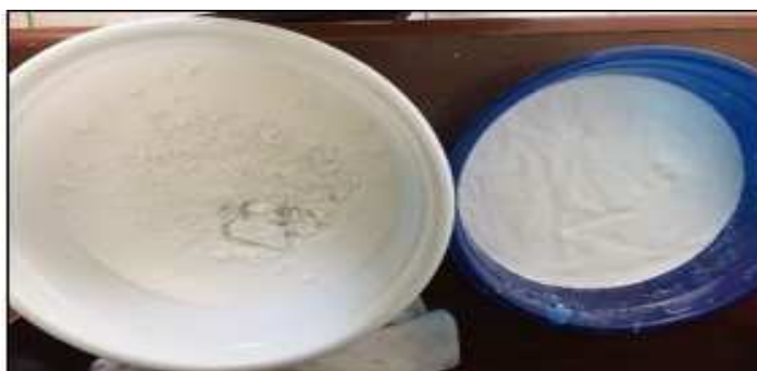
Figura 5 - Fécula resultante da massa ralada da mandioca, após decantação de 48 horas e fécula comprada pronta.
