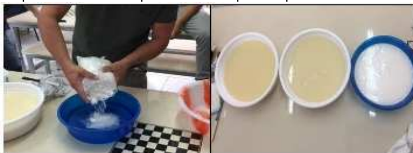
Figura 4 - Goma sendo misturada com água para controle, recipientes contendo líquido resultante prontos para decanta.
