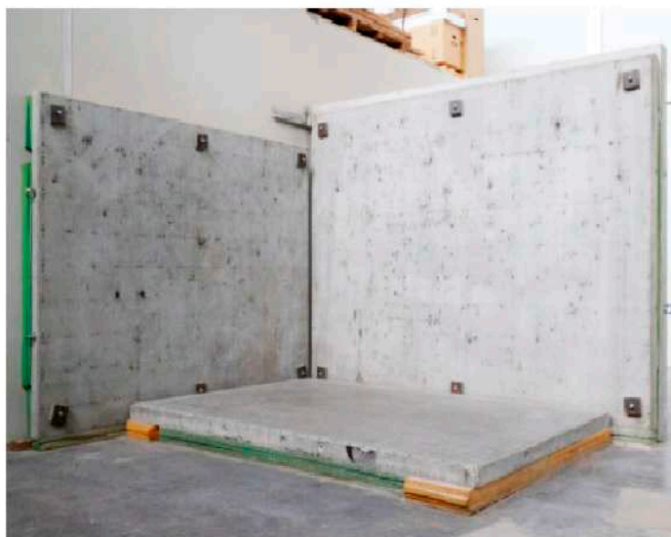
Figura 19: Modelo experimental de placas de concreto construído para validar modelo numérico em FEM.
