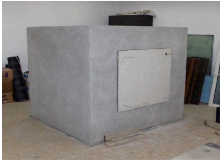
Figura 8: Câmara reverberante em escala construída para avaliar a transmissão do ruído de impacto em pisos.
