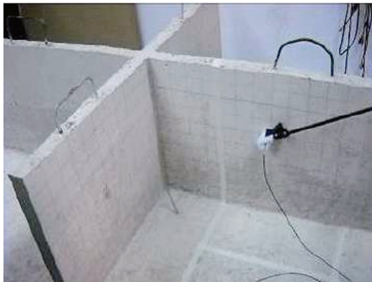
Figura 17: Determinação do índice K_{ij} por meio de análise experimental e numérica por FEM para diferentes tipos de uniões em placas de concreto.
