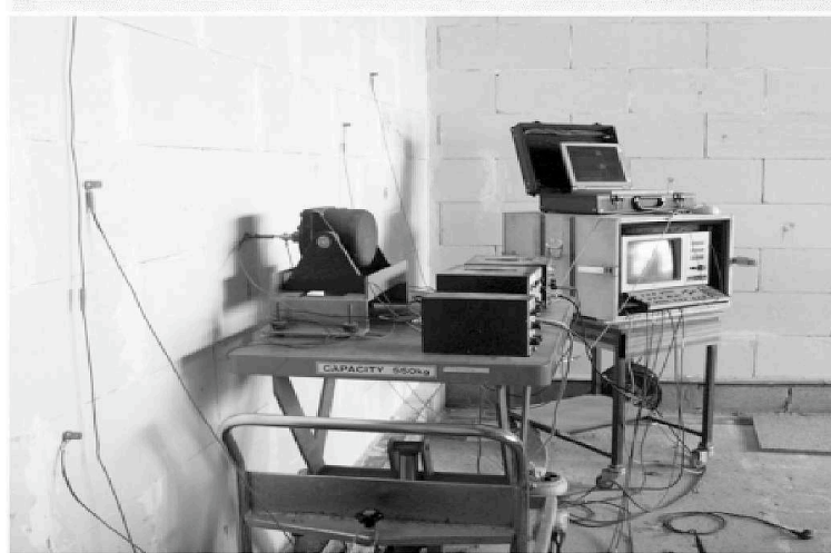
Figura 10: Instrumentação para avaliar o índice K_{ij} em campo para estruturas em T.
