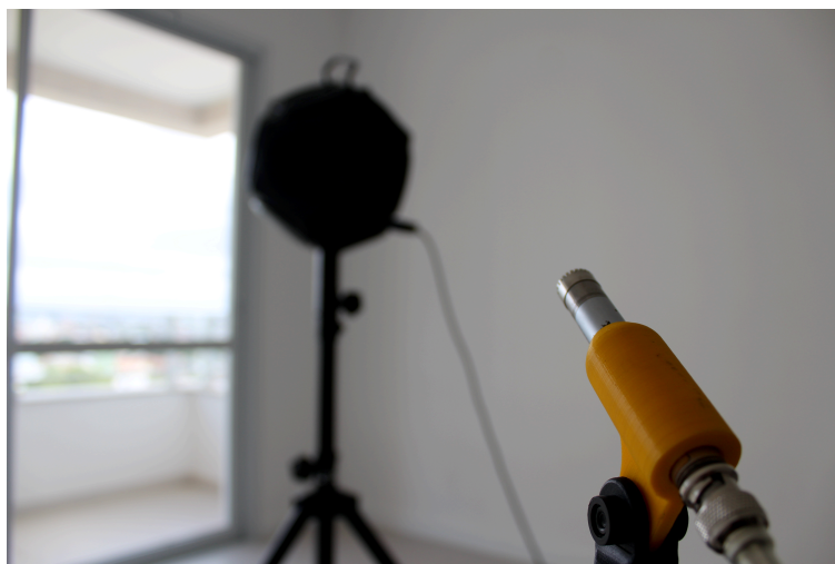
Figura 106: Medição do tempo de reverberação no ambiente abaixo da laje excitada.
