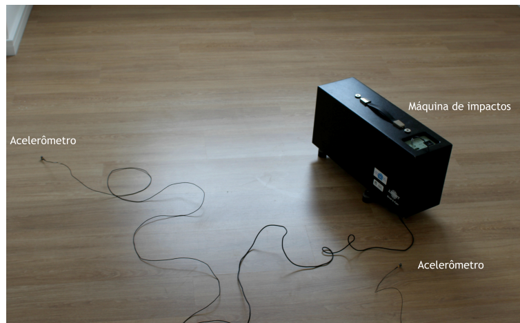
Figura 104: Máquina de impactos utilizada para avaliar a transmissão de energia vibratória no piso.
