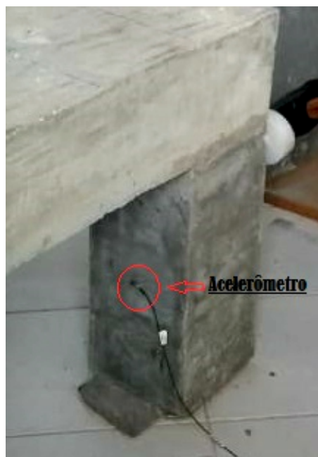
Figura 69: Acelerômetro fixado no pilar da bancada para medição do índice K_{ij} .
