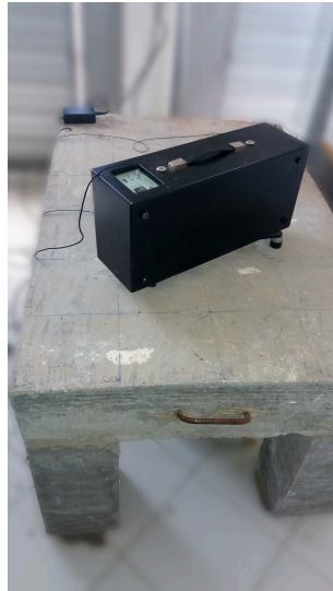
Figura 48: Posição da máquina de impactos na laje.
