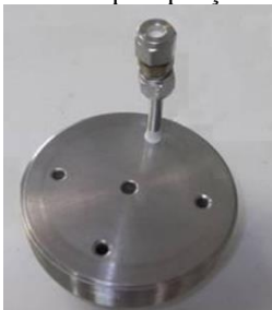
Figura 8 - Parte interna da câmara de precipitação com suporte de filtros.
