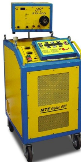
Figura 3.1 - Foto ilustrativa da fonte de soldagem modelo MTE DIGITEC 600.
