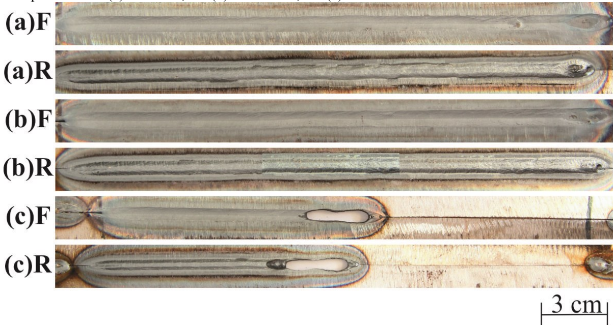
Figura 5.58 - Imagens das superfícies e raízes dos cordões de solda obtidos pelo processo TIG autógeno com aplicação do switch back para uma V_s = 30 cm/min e I_m = 180 A em chapa de 2 mm de espessura. Em (a): f = 5 Hz, em (b): f = 6 Hz e; em (c): f = 7 Hz.
