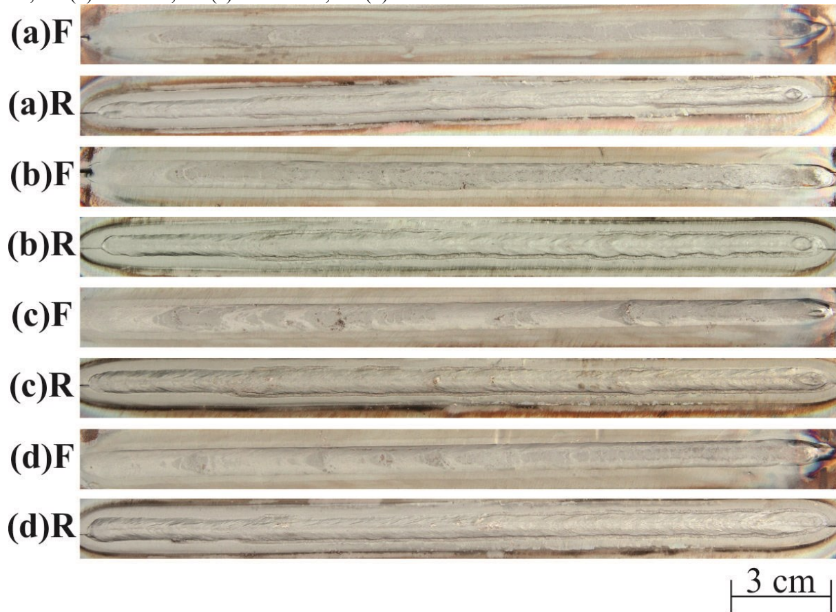
Figura 5.65 - Imagens da Face e Raiz dos cordões de solda realizados com o processo TIG autógeno com a aplicação da técnica switch back para uma V_s = 20 cm/min, I_m = 190 e A = 8 mm. Em (a): f = 5 Hz, em (b): f = 6 Hz, em (c): f = 7 Hz e; em (d): f = 8 Hz.
