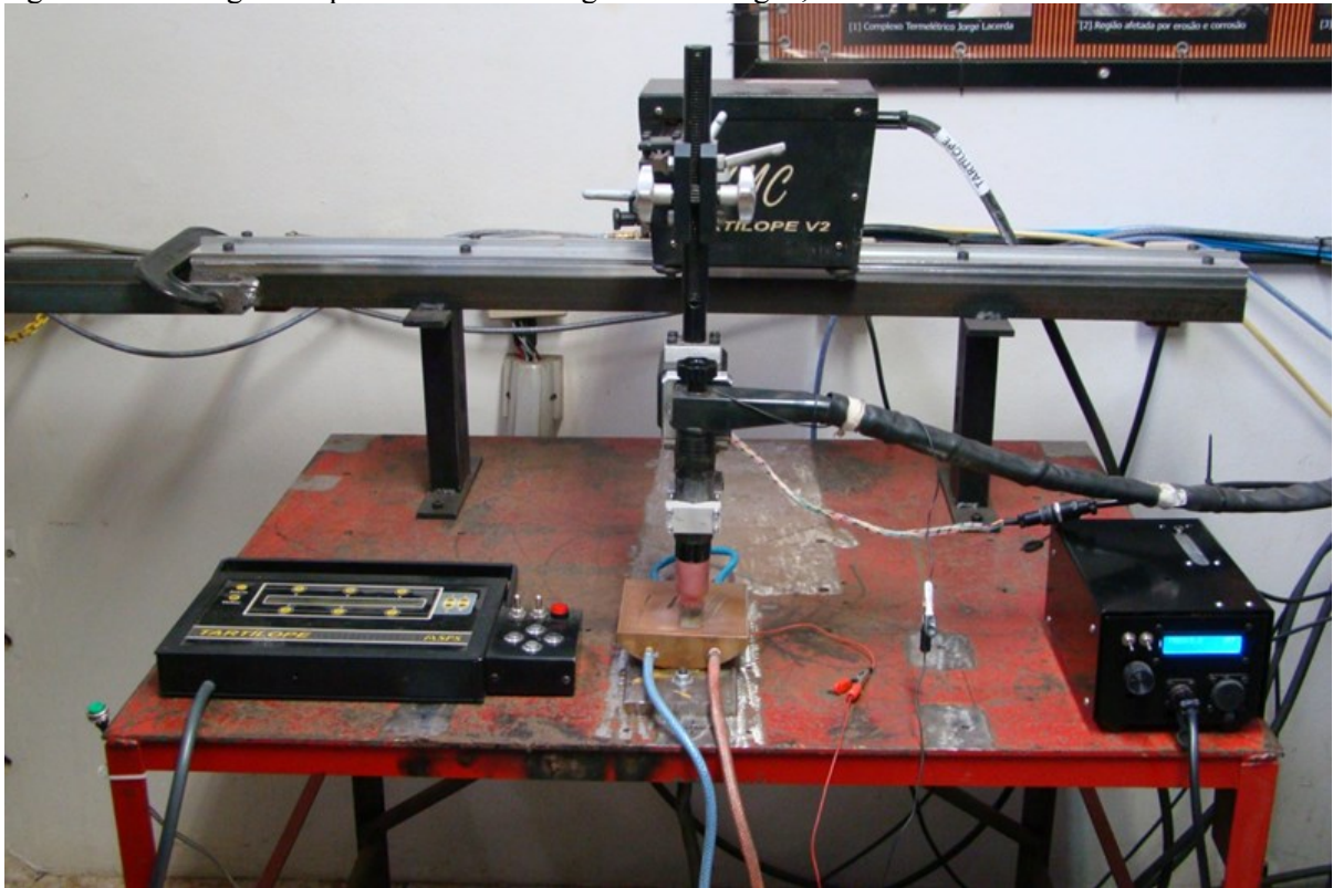
Figura 3.22 - Imagem da placa de cobre refrigerada com água, fixada sobre a bancada de ensaios.
