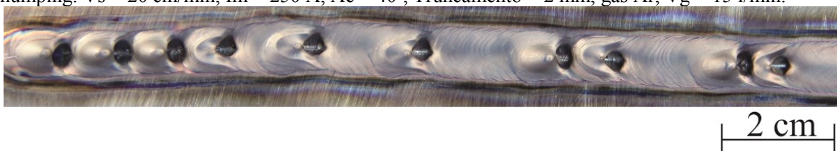
Figura 2.2 - Soldagem TIG autógena no modo convencional mostrando a formação do defeito de humping . V_s = 20 cm/min, I_m = 250 A, A_e = 40^\circ , Truncamento = 2 mm, gás Ar, V_g = 15 l/min.
