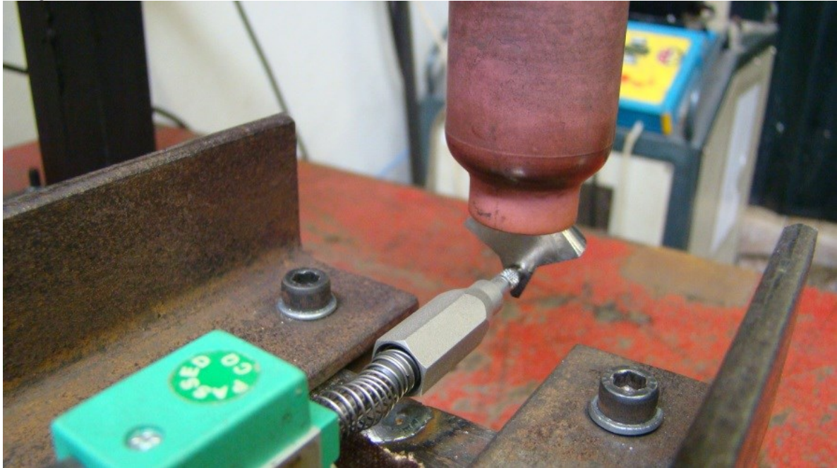
Figura 3.20 - Posicionamento do medidor de deslocamento linear em relação ao gabarito da tocha de soldagem.
