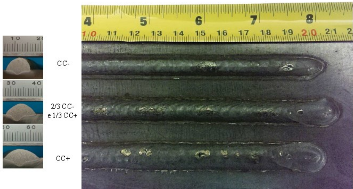
Figura 2.25 - Macrografias e visão superior dos cordões de solda obtidos ao se fazer a inversão de polaridade da corrente elétrica.
