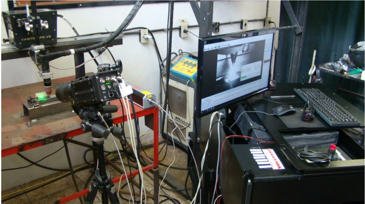
Figura 3.26 - Imagem da bancada de ensaios para execução da filmagem com a câmera de alta velocidade das soldas sobre chapa com o switch back.
