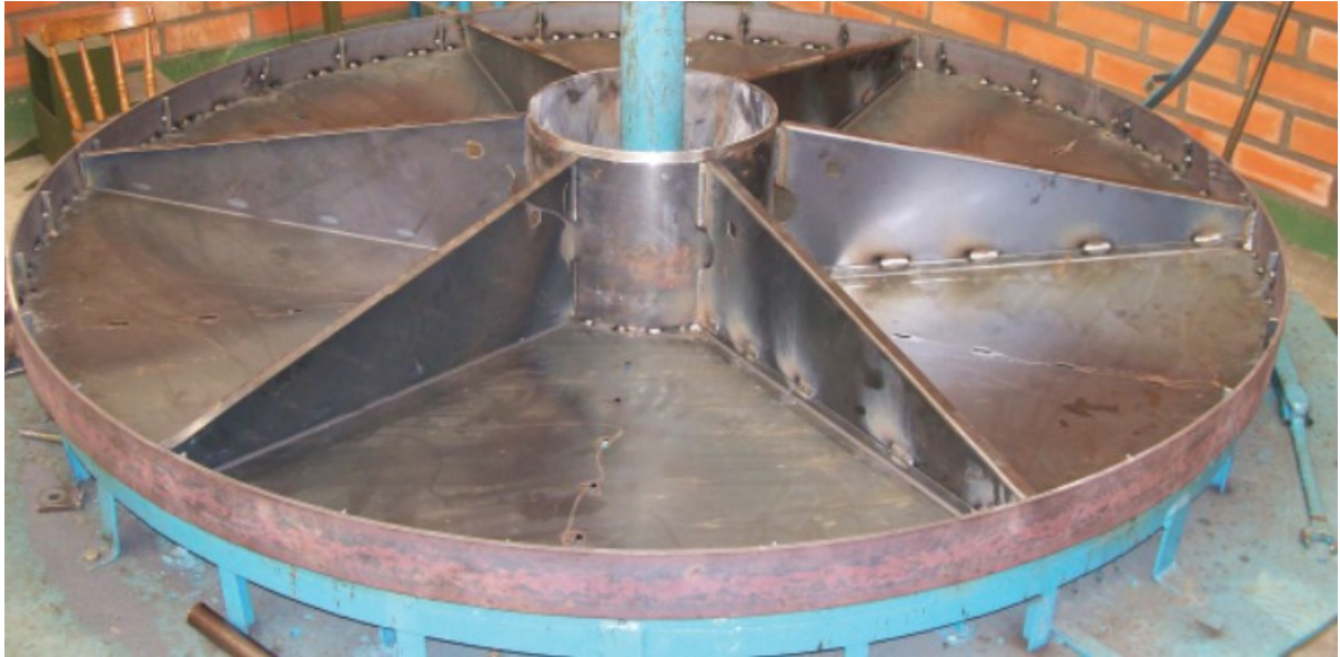
Figura 2.15 - União dos componentes da roda de aço dos tratores pelo processo de soldagem MIG/MAG.
