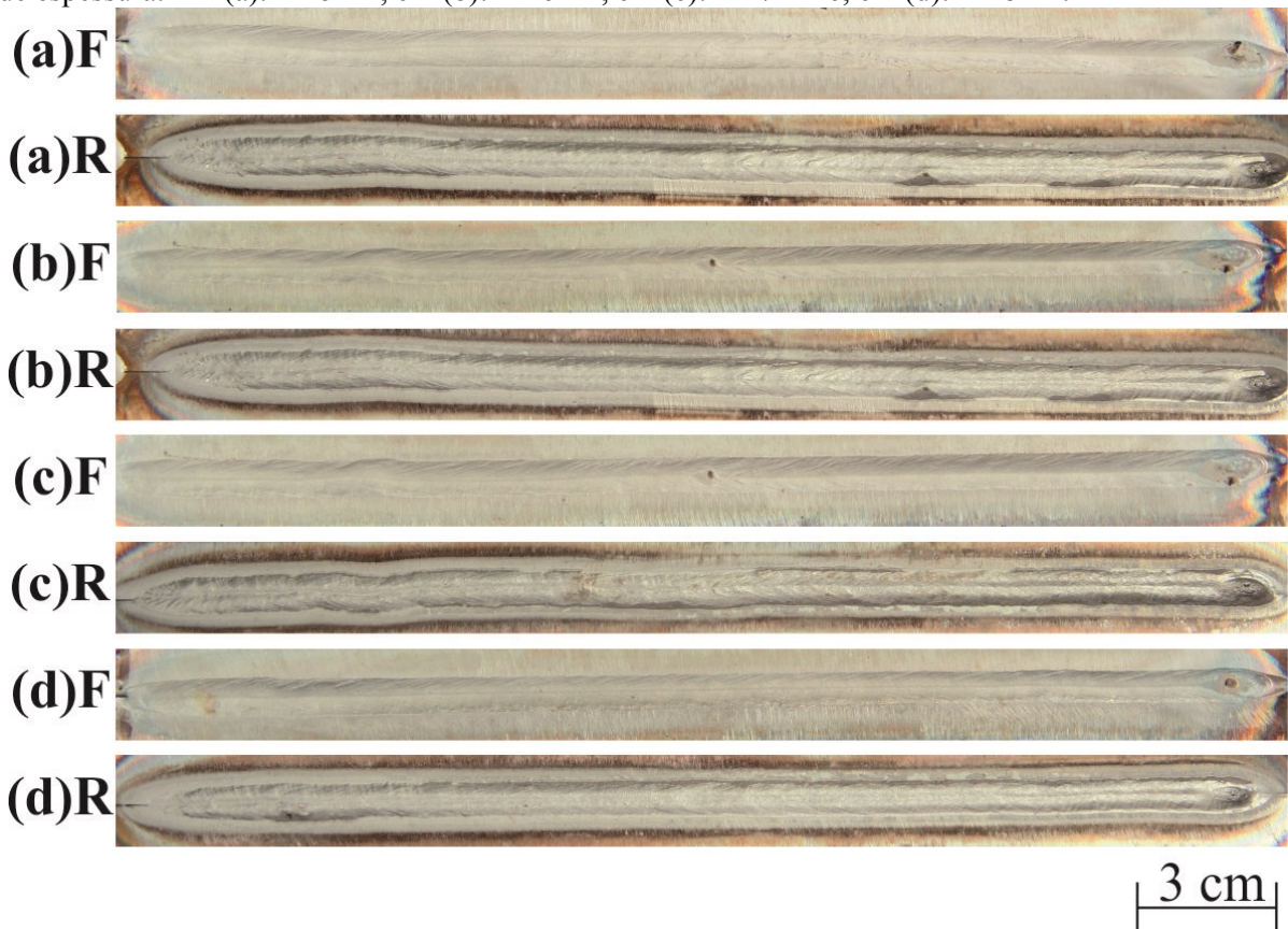
Figura 5.57 - Imagens das superfícies e raízes dos cordões de solda obtidos pelo processo TIG autógeno com aplicação do switch back para uma V_s = 20 cm/min e I_m = 150 A em chapa de 2 mm de espessura. Em (a): f = 5 Hz, em (b): f = 6 Hz, em (c): f = 7 Hz e; em (d): f = 8 Hz.
