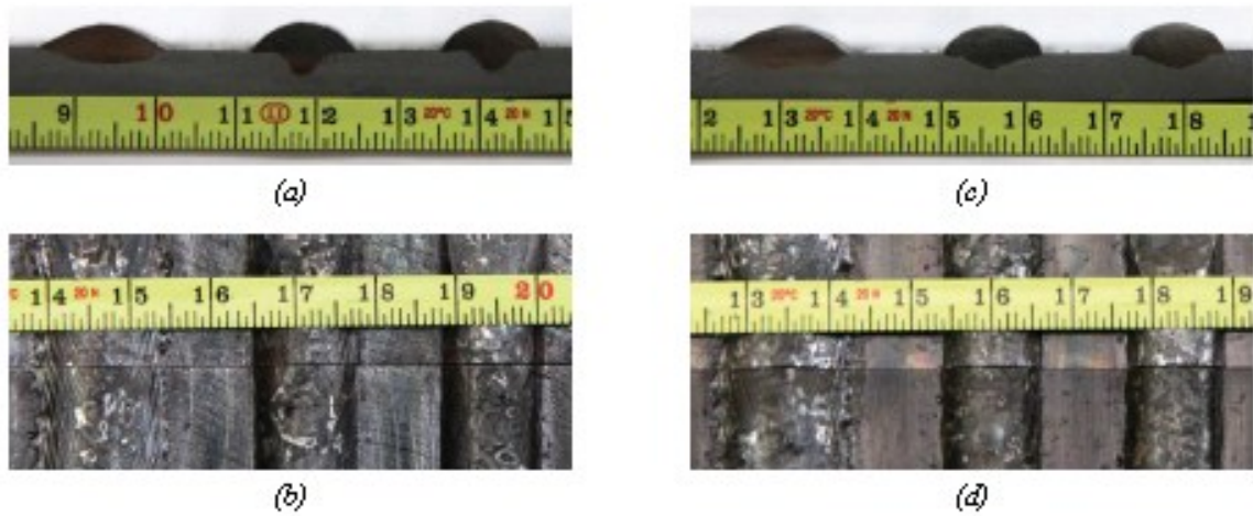
Figura 2.23 - Corte transversal e vista superior de cordões de solda para revestimento com e sem inclinação da tocha.
