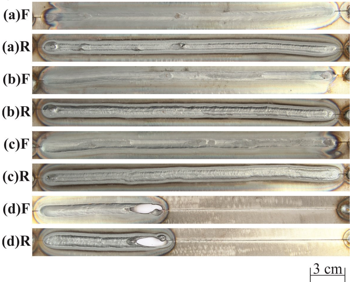
Figura 5.54 - Imagens da Face e Raiz dos cordões de solda realizados com o processo TIG autógeno convencional para uma V_s = 30 cm/min. Em (a): 160 A, em (b): 170 A, em (c): 180 A e; em (d): 190 A.
