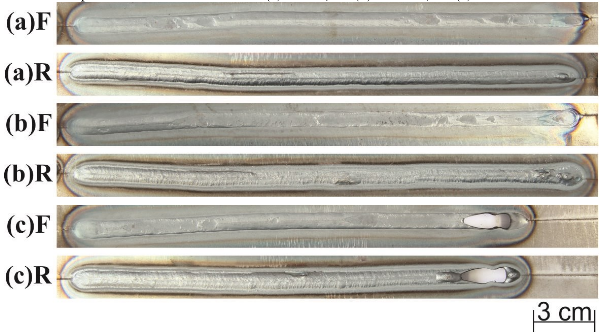
Figura 5.55 - Imagens da Face e Raiz dos cordões de solda realizados com o processo TIG autógeno convencional para uma V_s = 40 cm/min. Em (a): 190 A, em (b): 200 A e; em (c): 210 A.
