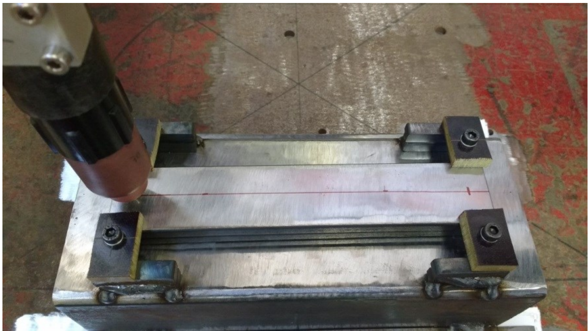
Figura 3.27 - Fixação do corpo de prova no suporte da bancada, utilizando peças de Celeron.
