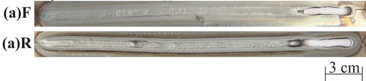
Figura 5.56 - Imagem da Face e Raiz do cordão de solda realizado com o processo TIG autógeno convencional para uma V_s = 50 cm/min. Em (a): 210 A.
