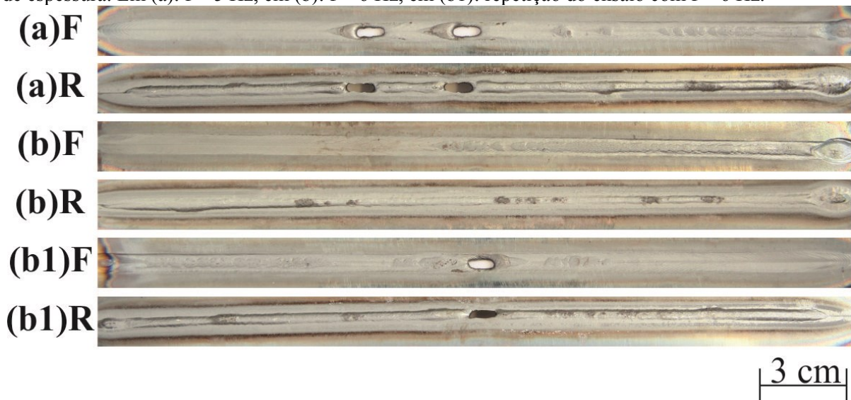
Figura 5.61 - Imagens das superfícies e raízes dos cordões de solda obtidos pelo processo TIG autógeno com aplicação do switch back para uma V_s = 60 cm/min e I_m = 240 A em chapa de 2 mm de espessura. Em (a): f = 5 Hz, em (b): f = 6 Hz, em (b1): repetição do ensaio com f = 6 Hz.
