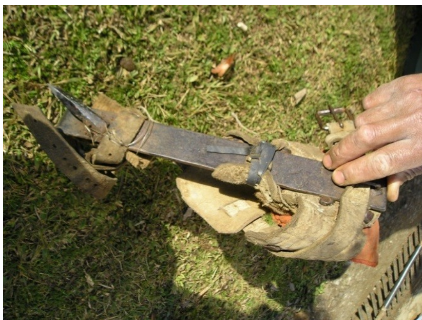
Figura 15 - Equipamento denominado de espora desenvolvido para escalar o pinheiro brasileiro, São Joaquim (SC).
