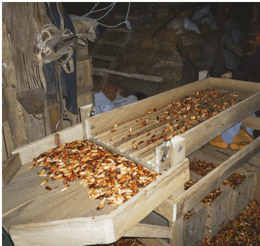
Figura 17 - Máquina adaptada para separar a falha dos pinhões, equipamento idealizado pelos extrativistas de São Joaquim (SC).
