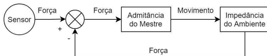
Figura 10 – Controle de impedância/admitância do sistema de teleoperação.
