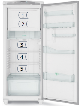
Figura 5.1: Posicionamento dos termopares no interior do refrigerador
