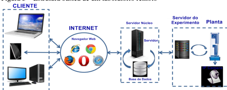
Figura 3 – Estrutura básica de um laboratório remoto
