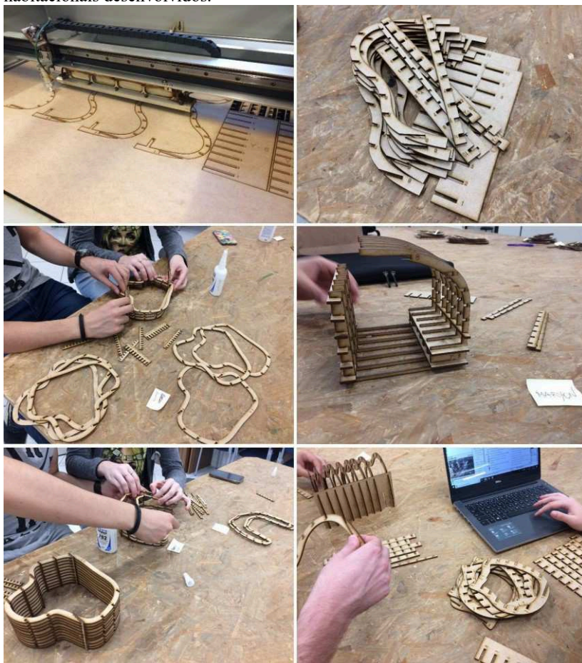
Figura 19 - Prototipagem com corte à laser e montagem dos módulos habitacionais desenvolvidos.
