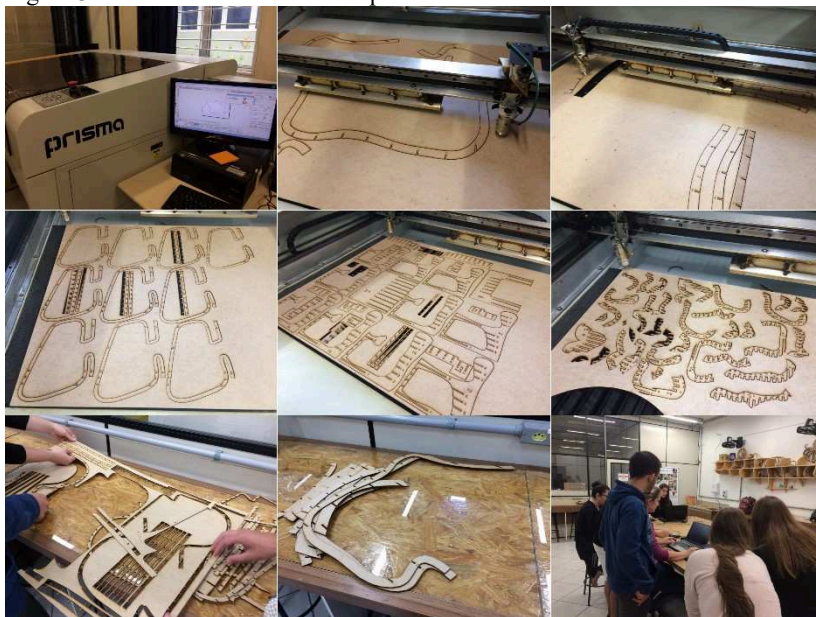
Figura 34 - Corte a laser dos Protótipos - turmas A e B.
