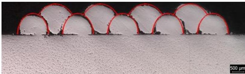
Figura 104. Validação do modelo proposto por Ocelík modificado, para o processo de DDE-L considerando o material ferro, estratégia de deposição alternada, razão de sobreposição (OR) de 32% e fatores de correção de 10% para largura e 28% para área.
