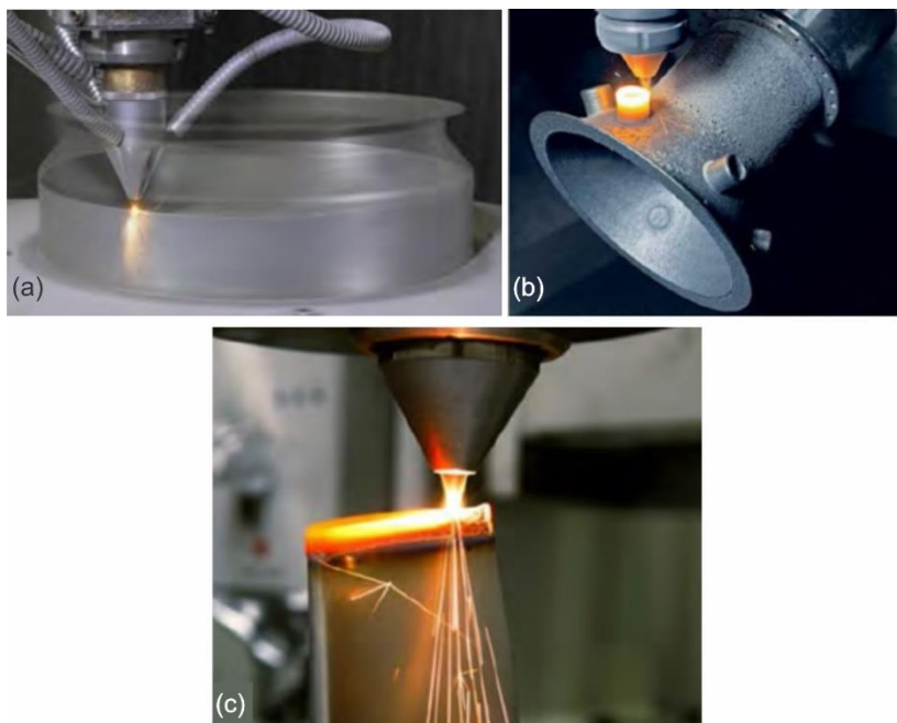
Figura 8. Aplicações do processo de DDE-L. (a) Fabricação de um componente camada por camada. (b) Construção de estruturas complementares sobre um componente já processado. (c) Reparo de peças de alto valor agregado [50][51][52]
