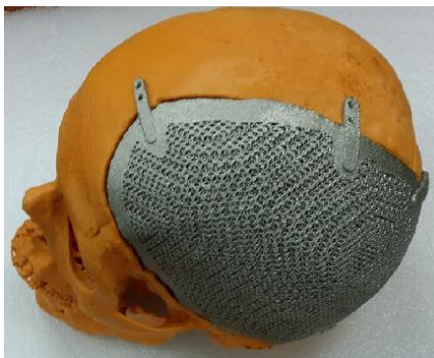
Figura 5. Implante de crânio com estrutura porosa fabricado por manufatura aditiva em titânio [46]
