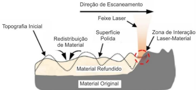
Figura 46. Desenho esquemático relativo ao princípio de funcionamento do processo de refusão a laser [102]
