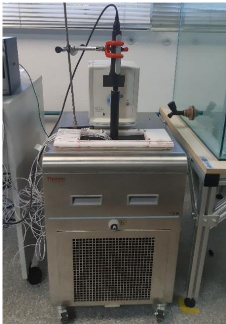
Figura A.17- Banho termostático com os RTDs e a sonda posicionados para calibração.
