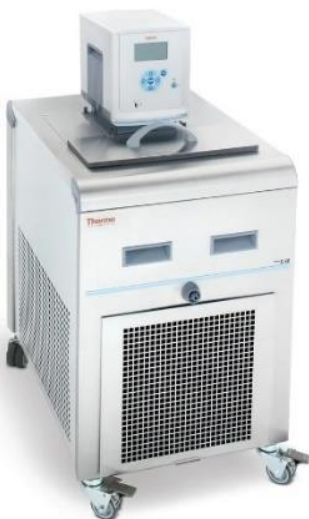
Figura A.10- Banho termostático Thermo Scientific® G50 utilizado para calibração.
