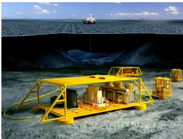
Figura 1.1- Ilustração de uma rede de alimentação submarina. Fonte: Parente (2015).
