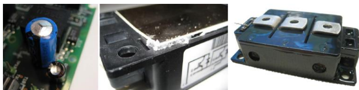
Figura 2.3 – Falhas nos componentes após exposição à elevada pressão hidrostática; esquerda: capacitor no IGBT gate driver; centro: módulo IGBT comercial sem modificações; direita: IGBT modificado para tolerar altas pressões. Fonte: Pittini et. al (2011).
