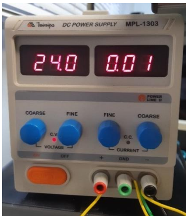
Figura A.3- Fonte de corrente contínua utilizada para a calibração do fluxímetro.
