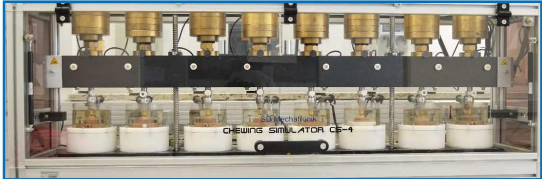
Um dispositivo metálico foi confeccionado contendo uma esfera metálica com diâmetro de 6 mm para ficar posicionado no centro da face oclusal e em contato com as cúspides. Dentro das câmaras do simulador de mastigação, os espécimes foram posicionados e fixados em dispositivo de modo que permanecessem estáveis no decorrer do teste. O dispositivo com a esfera se manteve paralelamente ao longo eixo do espécime durante todo o processo.
