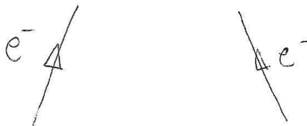
Figura 7 - Elétrons se aproximam, sentindo uma interação eletromagnética de repulsão, pois tem cargas de mesmo sinal (-).
