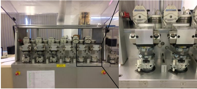
Figura 15: Equipamento para ensaio de desgaste de próteses totais de quadril
