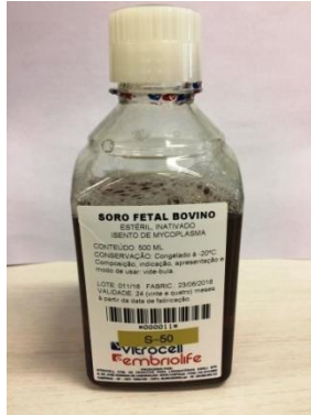
Figura 18: Frasco com soro fetal bovino usado como fluido lubrificante
