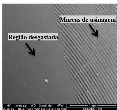
Figura 43: Imagens de MEV do Fabricante B com marcas de usinagem remanescentes (100X).
